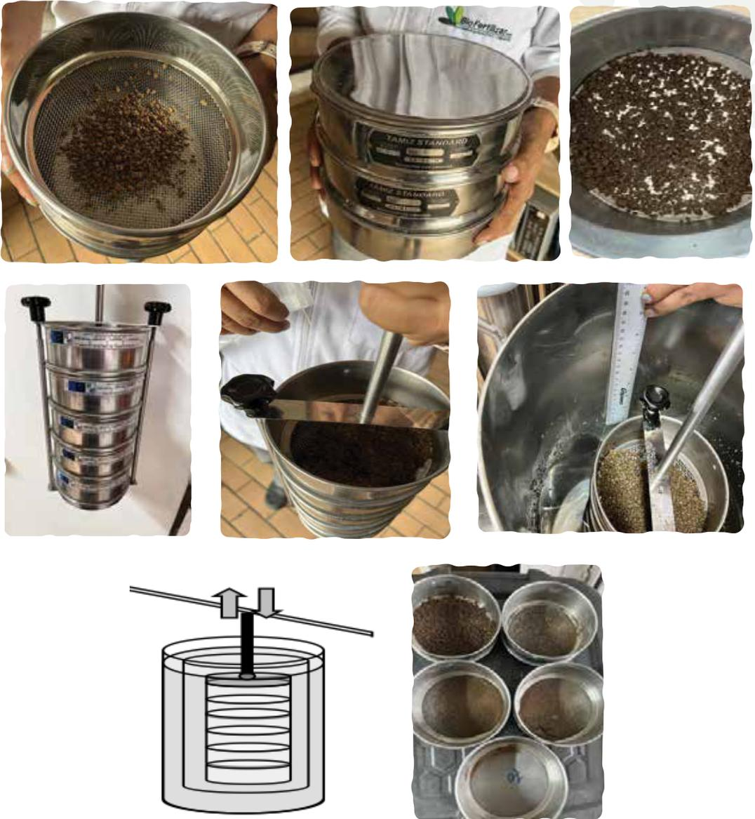
Figura 11. Medición de estabilidad de agregados con el método de Yoder.
