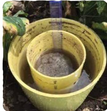
**Figura 13.** Implementos usados tradicionalmente para medir la infiltración con doble anillo.
