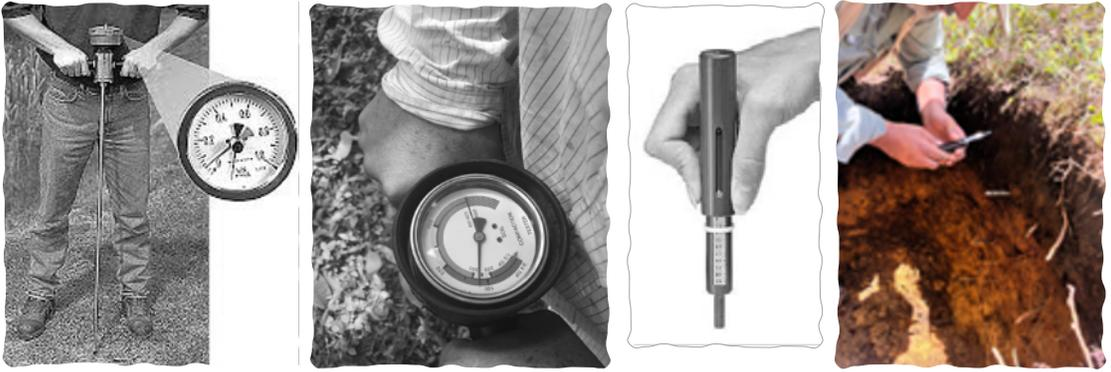
Figura 4. Uso de penetrómetro de punta (izquierda) y su respectivo manómetro (centro). Penetrómetro de bolsillo (derecha).
