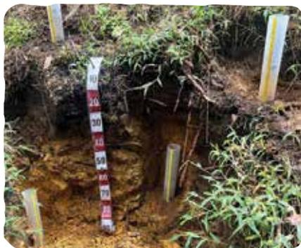
**Figura 14. a.** Medición de la infiltración de agua en el suelo a cuatro diferentes profundidades en una plantación de aguacate en Guarne.
